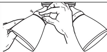
**12.** Установите стеклянные плафоны, закрепив их тремя винтами. **ОСТОРОЖНО!** Сильно затянутые винты могут повредить плафоны. Вкрутите в патроны лампы (E27 макс. 60 Вт каждая для ламп накаливания).
