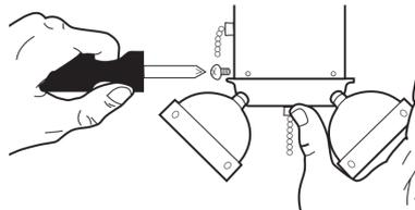
**11.** Закрепите светильник на корпусе вентилятора с помощью трех комплектов винтов и шайб.
