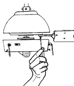
8. Закрепите держатели лопастей на корпусе вентилятора с помощью винтов и шайб.
