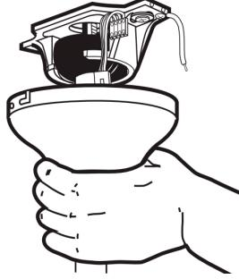
3. Поднимите вентилятор и временно подвесьте его на кронштейне за специальный крюк.
