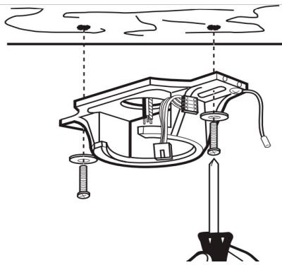
2. Просверлите два монтажных отверстия на потолке и надежно закрепите на нем кронштейн, используя для этого подходящие дюбели, шайбы и болты. Пропустите потолочные провода питания сквозь круглое отверстие в кронштейне.
