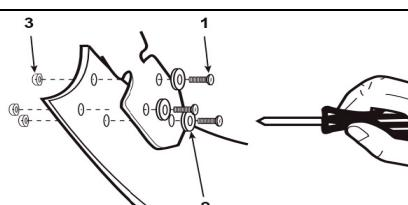
7. Прикрутите лопасти к держателям лопастей с помощью винтов (1), шайб (2), гаек (3).
