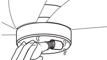
11. Установите лампу (тип E14 и макс. мощность не более 60 Вт для ламп накаливания).
