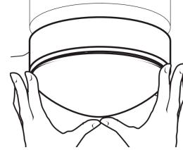
12. Установите стеклянный плафон, закрепив его тремя винтами. **ОСТОРОЖНО!** Не затягивайте винты очень сильно, чтобы не повредить плафон, он будет держаться за счет длины этих винтов.
