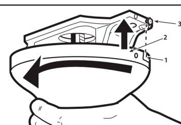
9. Продвиньте вверх припотолочный колпак, и закрепите его с помощью винтов и зубчатых шайб (3) сначала через Г-образные пазы (1), затем через пазы (2).
