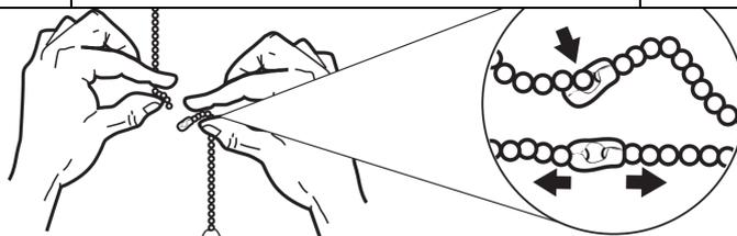
**13.** Прикрепите декоративную подвеску и удлиняющую цепь, находящиеся в комплекте с деталями, к цепи вентилятора, введя конец цепи в цепное соединение. Проверьте надежность установки, слегка потянув за обе цепи в месте соединения.
