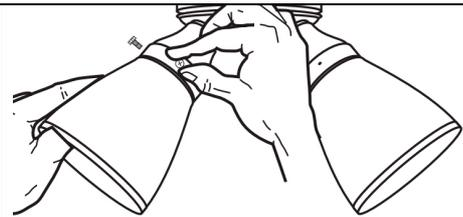
**12.** Установите стеклянные плафоны, закрепив их тремя винтами. **ОСТОРОЖНО!** Сильно затянутые винты могут повредить плафоны. Вкрутите в патроны лампы (E27 макс. 60 Вт каждая для ламп накаливания).
