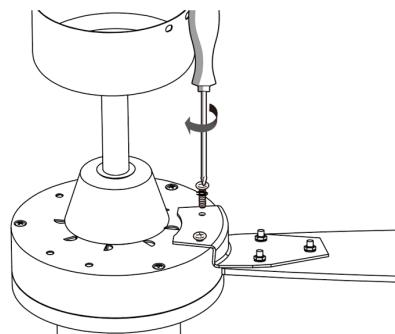
8. Закрепите держатели лопастей на корпусе вентилятора с помощью винтов и шайб, располагая головки винтов со стороны нижней плоскости лопасти.
