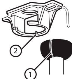
4. Поворачивайте вентилятор до тех пор, пока выступ (2) кронштейна не войдет в выемку на полусфере штанги (1).
