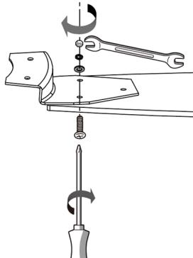
7. Прикрутите лопасти к держателям лопастей с помощью винтов, шайб, гаек.
