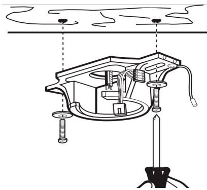
2. Просверлите два монтажных отверстия на потолке и надежно закрепите на нем кронштейн, используя для этого подходящие дюбели, шайбы и болты. Пропустите потолочные провода питания сквозь круглое отверстие в кронштейне.
