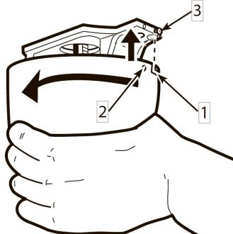
9. Продвиньте вверх припотолочный колпак, и закрепите его с помощью винтов и зубчатых шайб (3) сначала через Г-образные пазы (1), затем через пазы (2).
