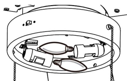
11. Установите 2 лампы (тип E14 и макс. мощность каждой не более 60 Вт для ламп накаливания).
