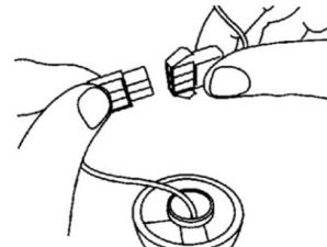
6. Плотно соедините штекера встречных четырехразъемных электрических клемм до щелчка.
