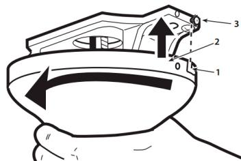
**7.** Продвиньте вверх припотолочный колпак, и закрепите его с помощью винтов и зубчатых шайб (3) сначала через Г-образные пазы (1), затем через пазы (2).
