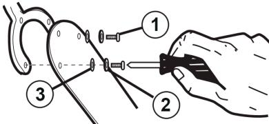
**8.** Прикрутите лопасти вентилятора к U-образным металлическим держателям лопастей с помощью винтов (1), шайб (2) и бумажных шайб (3) из комплекта поставки.
