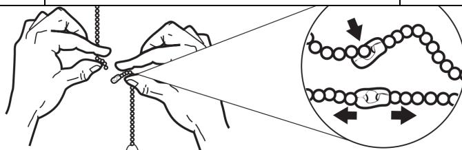
13. Прикрепите декоративную подвеску и удлиняющую цепь, находящиеся в комплекте с деталями, к цепи вентилятора, введя конец цепи в цепное соединение. Проверьте надежность установки, слегка потянув за обе цепи в месте соединения.
