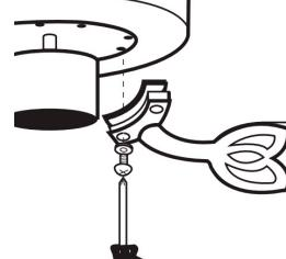
**9.** Закрепите держатели лопастей на корпусе вентилятора с помощью винтов и шайб из комплекта поставки.
