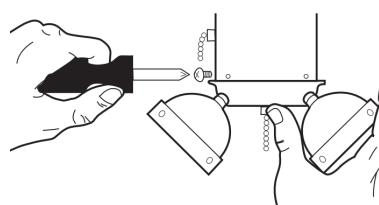
11. Закрепите светильник на корпусе вентилятора с помощью трех комплектов винтов и шайб.
