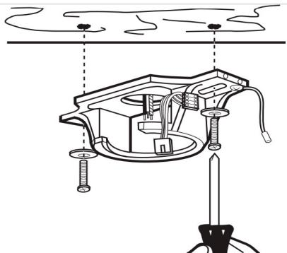
**2.** Просверлите два монтажных отверстия на потолке и надежно закрепите на нем кронштейн, используя для этого подходящие дюбели, шайбы и болты. Пропустите потолочные провода питания сквозь круглое отверстие в кронштейне.
