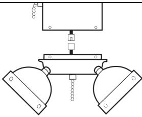
10. Соедините шлейфы на светильнике и корпусе вентилятора.
