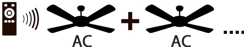
Подключение нескольких (но не более восьми) потолочных вентиляторов Dreamfan с АС двигателем к одному пульту ДУ возможно!
