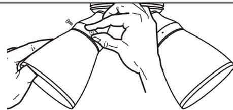
12. Установите стеклянные плафоны, закрепив их тремя винтами. **ОСТОРОЖНО!** Сильно затянутые винты могут повредить плафоны. Вкрутите в патроны лампы (E14 макс. 60 Вт каждая для ламп накаливания).
