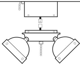
10. Соедините шлейфы на светильнике и корпусе вентилятора.
