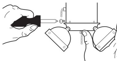
11. Закрепите светильник на корпусе вентилятора с помощью трех комплектов винтов и шайб.
