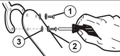
8. Прикрутите лопасти вентилятора к U-образным металлическим держателям лопастей с помощью винтов (1), шайб (2) и бумажных шайб (3) из комплекта поставки, располагая головки винтов на верхней плоскости лопастей.
