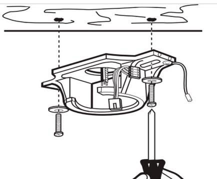
2. Просверлите два монтажных отверстия на потолке и надежно закрепите на нем кронштейн, используя для этого подходящие дюбели, шайбы и болты. Пропустите потолочные провода питания сквозь круглое отверстие в кронштейне.
