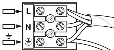
5. Подключите провода питания с помощью монтажных клемм по схеме:
