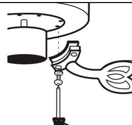
9. Закрепите держатели лопастей на корпусе вентилятора с помощью винтов и шайб из комплекта поставки.
