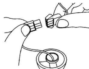
6. Плотно соедините штекера встречных четырехразъемных электрических клемм до щелчка.
